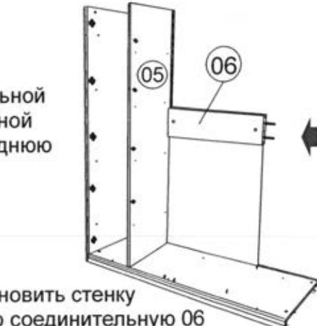
Установить стенку вертикальную соединительную 06 и закрепить на эксцентриковую стяжку.
