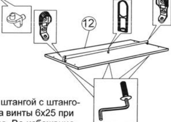
Полку 12 оборудовать штангой с штангодержателями, закрепив их на винты 6x25 при помощи шестигранного ключа. Во избежание повреждения вертикальных стенок, при установке полки в корпус шкафа, при оборудовании полки штангодержателями обратить особое внимание: штангодержатель не должен выходить за уровень кромки полки.
