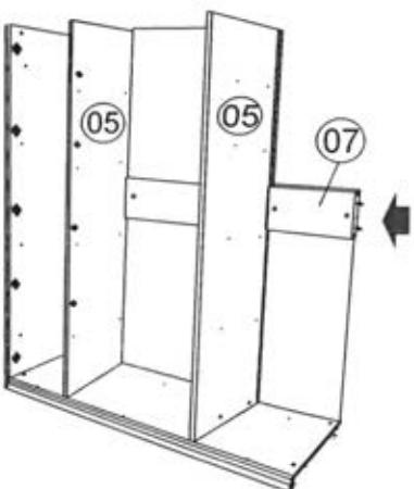
В отверстие на пласти стенки вертикальной 05 вставить шток эксцентрика двухсторонней длинной стороной, вставив его в эксцентрик стенки 06 и зафиксировать.
