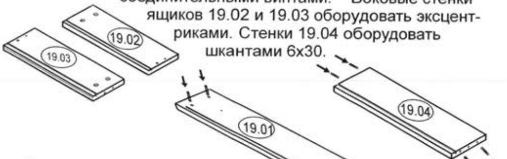
Боковые стенки ящиков 19.02 и 19.03 с внешней стороны по имеющимся наколкам оборудовать демпферами и зафиксировать на шурупы 3.5x13.
