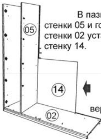
В пазы вертикальной стенки 05 и горизонтальной стенки 02 установить заднюю стенку 14.
