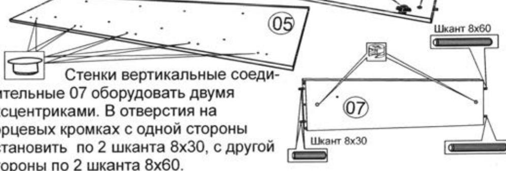
Стенки вертикальные соединительные 07 оборудовать двумя эксцентриками. В отверстия на торцевых кромках с одной стороны установить по 2 шкант 8x30, с другой стороны по 2 шкант 8x60.
