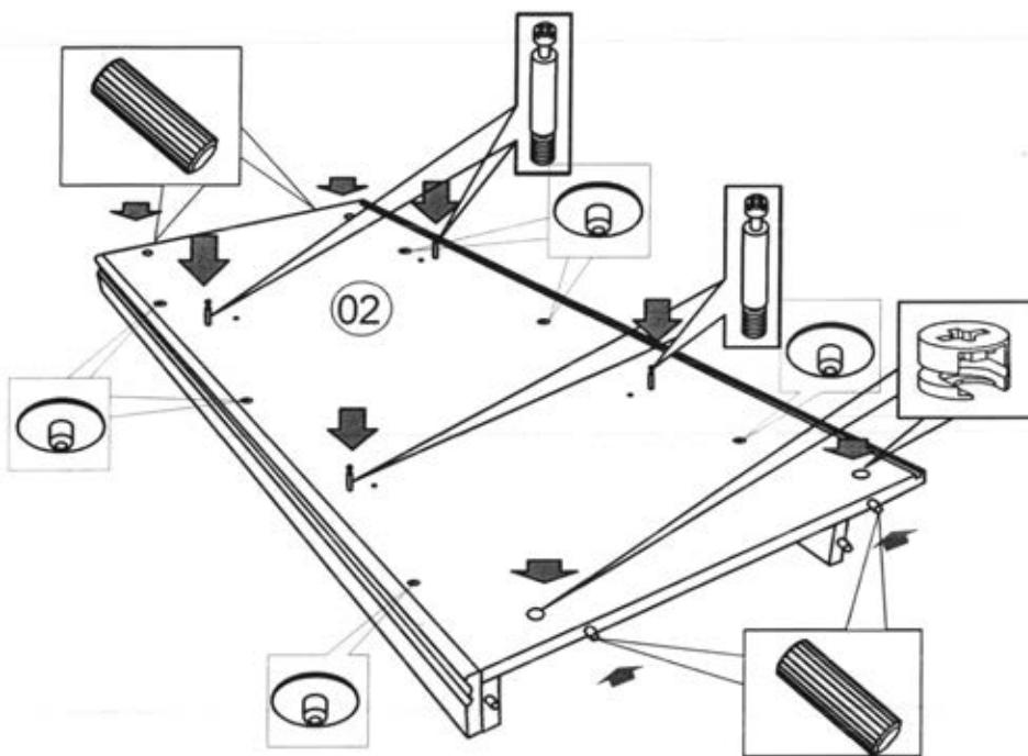
Стенки вертикальные 03 и 04 оборудовать 5-ю ответными планками D-3. В отверстия на пласти установить по 2 эксцентрика и 3 винта соединительных. В отверстия на верхней торцевой кромке установить по 2 шканта 8x30, на нижней по 2 наконечника.
