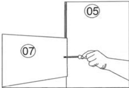
В отверстие на пласти стенки вертикальной 05 вставить шток эксцентрика двухстороннего длинной стороной, вставив его в эксцентрик стенки 07 и зафиксировать.
