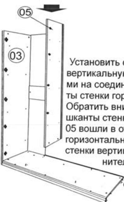
Установить стенку вертикальную 05 отверстиями на соединительные винты стенки горизонтальной 02. Обратить внимание, чтобы шканты стенки вертикальной 05 вошли в отверстия стенки горизонтальной 02, шканты стенки вертикальной соединительной 07 вошли в отверстия стенки 05.
