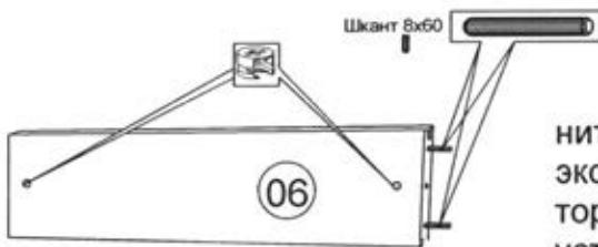
Стенку вертикальную соединительную 06 оборудовать двумя эксцентриками. В отверстия на торцевой кромке с одной стороны установить 2 шканта 8x60.
